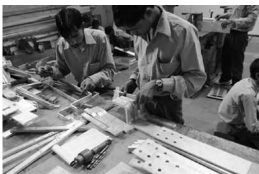
ブスバー製作(アルミ製)
