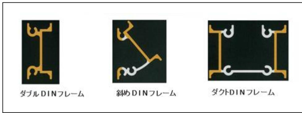
図 48. スケルトンラックの構成部材の断面
