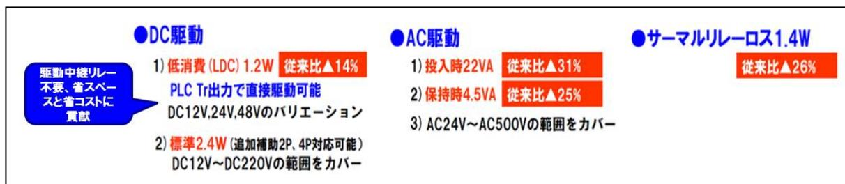
図 23. SK-series 電磁接触器の駆動回路の省電力化
